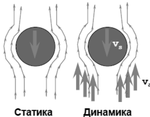
Рисунок 2. Проскальзывание частиц в динамическом и статическом состоянии.
