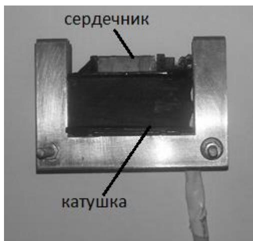
Рис.2 Электромагнит переменного тока
