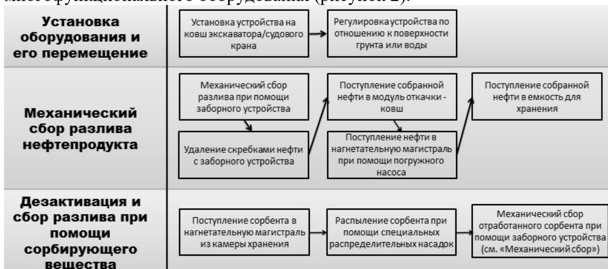
Рисунок 2. Схема работы универсальной установки, предназначенной для ликвидации разливов нефтепродуктов
