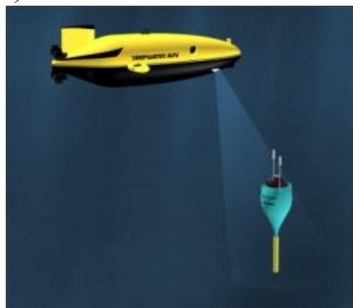
Рисунок 2. Считывание (видеозапись) данных коррозионного мониторинга морского трубопровода с применением ДУА. а, б – по средству видеозаписи; в, г – по акустическому каналу
