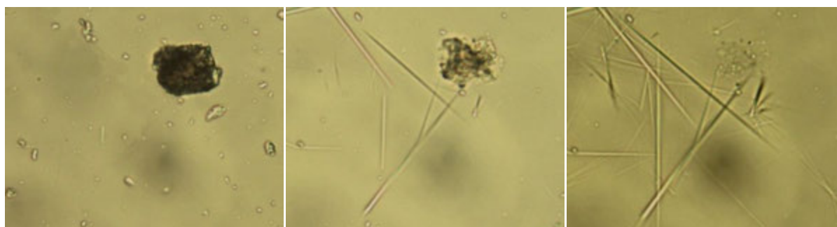
Рисунок 3. Микроскопические снимки процесса взаимодействия ПМК производства ОАО «Магнезит» с водным раствором MgCl_2 через 5 минут(а), через 30 минут (б), через 3 часа (в).
