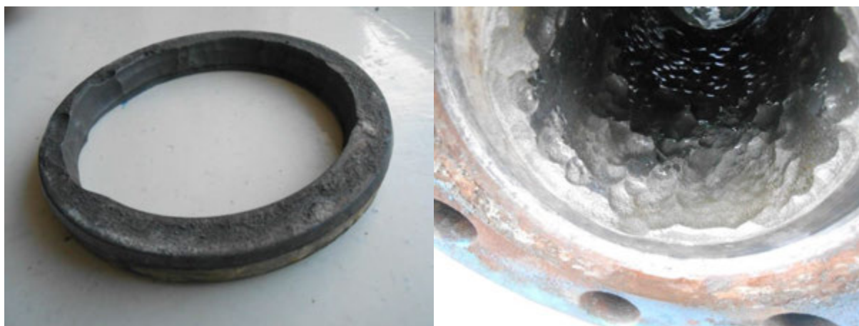
Рисунок 2. Разрушения, вызванные углекислотной коррозией
