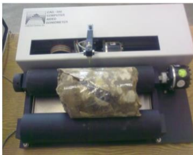
Рисунок 1. Цифровой полуавтоматический гониометр CAG -600 [2]
